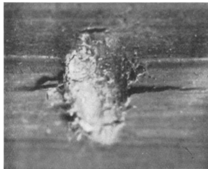
Abb. 11. Falzkante (Schlafzimmersseite). Das Holz ist nach unten zu aufgerissen, die freien Enden der Holzfasern zeigen nach unten.
